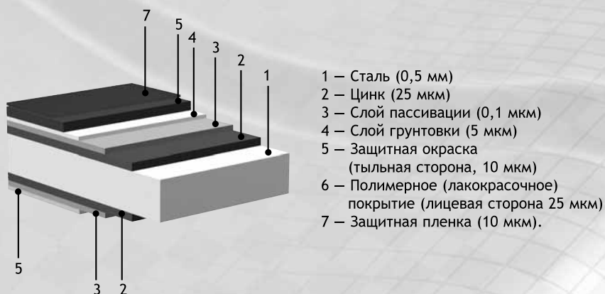
Рис. 1. Структура стального листа с полимерным покрытием
