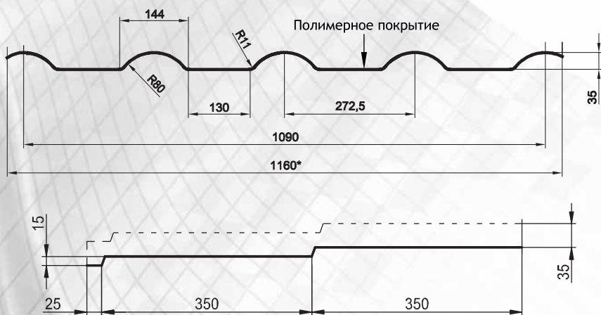
Рис. 4. Общий вид и размеры профиля «Дюна»
