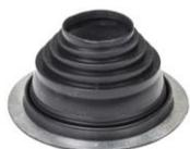
ROOFSEAL уплотнители предназначены для герметичной проводки труб, опор рекламных щитов, флагштоков, кабелей и т.д. через металлическую кровлю. Гибкий уплотнитель из EPDM -резины с фланцем, имеющим алюминиевое покрытие, допускает тепловые и механические колебания, герметизируя отверстие в кровле.
