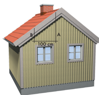
Рис. 2 Чтобы рассчитать наклон крыши, число (В) вычтите из числа (А) (см. таблицу 1).
