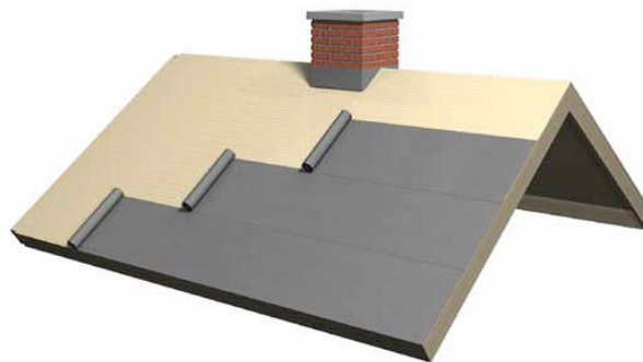
Рис. 3 Полотна гидроизоляции укладываются с нижней части крыши (карниза) до конька в горизонтальном положении и прижимаются вентиляционными брусочками.
