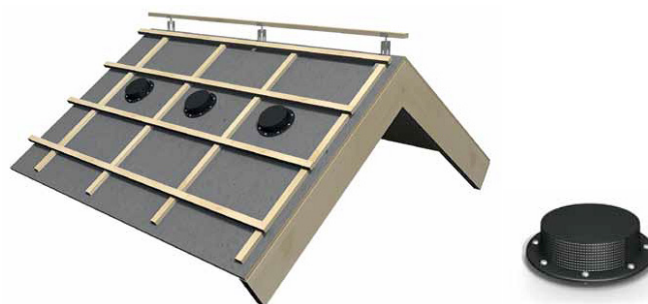
Рис. 4 При использовании сплошной нижней кровли из битумных или полимерных рулонных материалов, для обеспечения вентиляции конструкции крыши, используйте вентиляционные элементы
