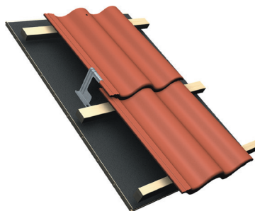
Рис. 26 Противочетной кляммер прибивается к обрешетке и крепко "сцепляет" верхнюю и нижнюю черепицы.
